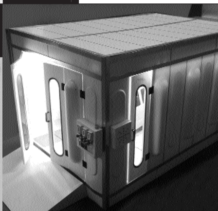
Cabina de repintado automotriz con sistema de secado con lámparas infrarrojas. Andrés Canchola Romero
