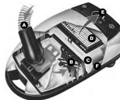
fig. 9 Componentes básicos de una aspiradora con sistema de filtrado HEPA
